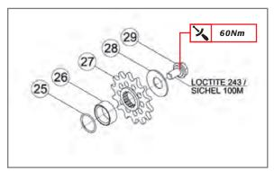
Exploded view of pinion. 25) O-ring 25x12x1.78; 26) Spacer 27) Pinion; 28) Washer; 29) Screw.
