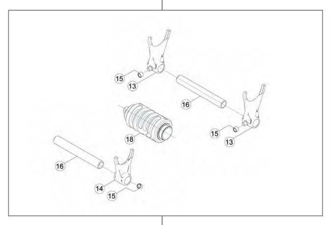
**EXPLODED VIEW OF INTERNAL GEARBOX CONTROL UNIT:**
